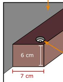
**WICHTIG:** wenn abgeschnitten wird, zusätzliche Bohrung und Senkung setzen!
