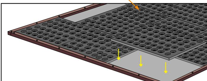
Komplette Fläche mit Untermatten fugenlos belegen, bei Bedarf Matten zurechtschneiden und einpassen
